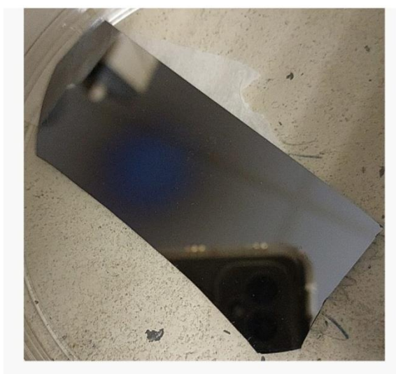
Figura 3 - Resultado da deposição de filme fino de \text{SiO}_2 da Amostra.
