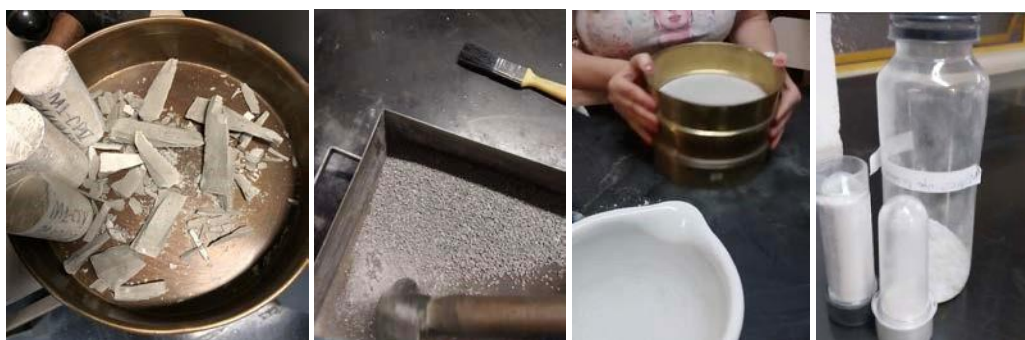
Fig. 4 – Sequência no preparo das AMs (ruptura, cominuição, peneiramento e separação) para ensaios diversos
