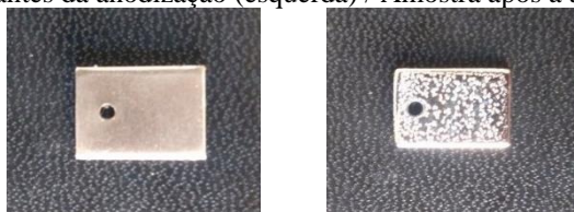
Fig. 4 – Amostra antes da anodização (esquerda) / Amostra após a anodização (direita)
