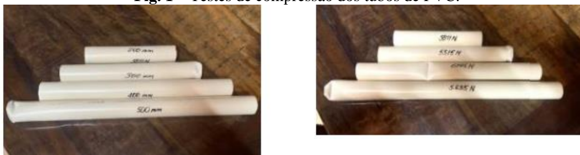
Fig. 1 – Testes de compressão dos tubos de PVC.
