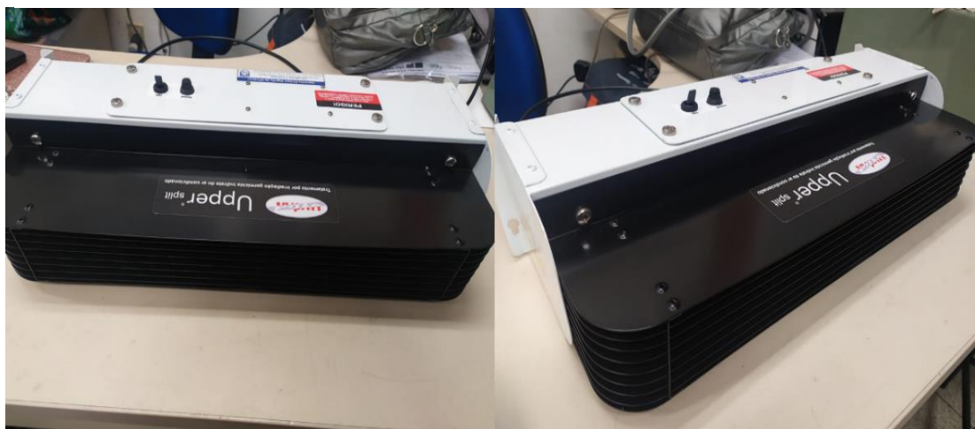
Fig. 1 – Sistema Upper Split para desinfecção de ar por radiação UV.
