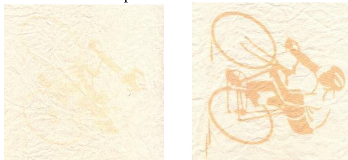
Fig. 6. Tecido tratado com plasma, sem tratamento plasma, estampado com corante açafão e espessante tamarindo
